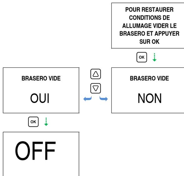
**i** Si, suite à la pression de la touche ON/OFF, apparaît le message « PELLET ÉPUISE », il est possible de poursuivre avec la commande seulement après avoir rempli le réservoir de granulés. Consultez l'option « PELLET ÉPUISE ».
