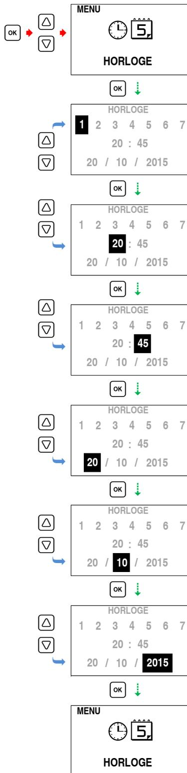
**i** Le produit quitte l'usine avec l'horloge déjà réglée, il vous suffit donc de contrôler si l'heure est correcte ou si elle correspond éventuellement à l'heure courante. Il est nécessaire de régler précisément l'horloge afin de pouvoir utiliser toutes les fonctions qui en prévoient l'utilisation.
