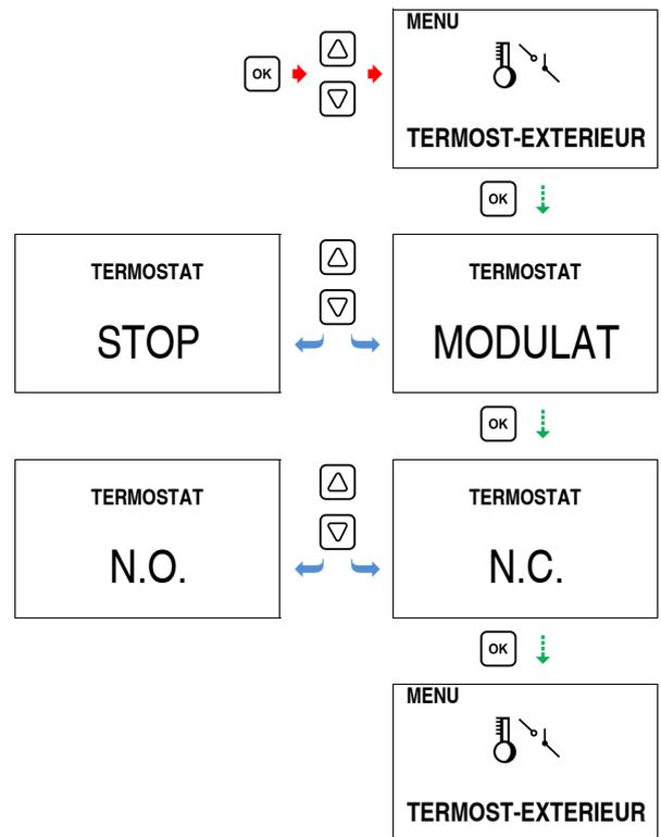
Pour activer le thermostat extérieur, régler la température ambiante désirée sur le thermostat extérieur.
