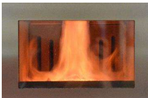
La flamme inversée de la chambre de combustion inférieure.
