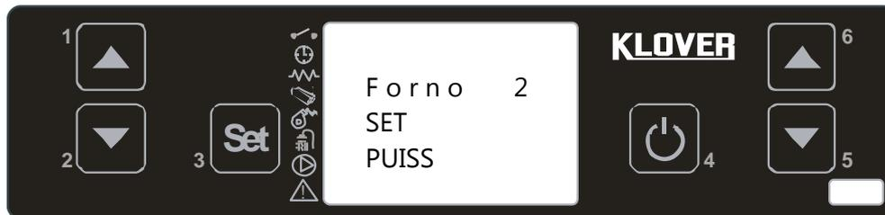
En configurant une des trois PUISSANCES FOUR, on ignore le fonctionnement du thermostat ambiant (ou de tout autre thermostat associé) et la cuisinière modulera donc, puis s'éteindra seulement si la température configurée sur le SET FOUR est atteinte .
