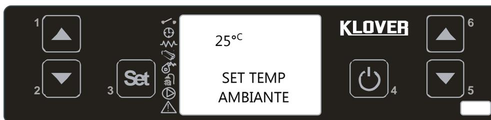
Après avoir configuré la valeur souhaitée, confirmer en appuyant sur la touche 4 ou bien attendre quelques secondes. Si la température ambiante sélectionnée est atteinte, l'appareil effectue la même procédure que lors de l'ouverture du thermostat d'ambiance (voir « Raccordement au thermostat d'ambiance »).
