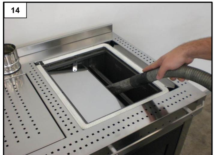
Avec la brosse à ramoner fournie, racler autour des parois (figure 13) et aspirer l'éventuel dépôt de suie (figure 14). Après avoir effectué le nettoyage, replacer le déflecteur de fumées et la plaque de cuisson en faisant attention que celle-ci soit mise en étanchéité contre les fumées d'évacuation.
