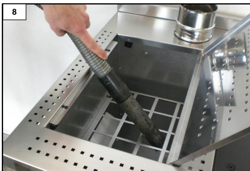
Pour un fonctionnement correct, il est nécessaire d'aspirer le dépôt de sciure sur le fond du réservoir (figure 8) au moins tous les 15 jours. **À chaque fin de saison, il faut vider complètement le réservoir à granulés.**
