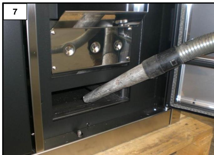
Après avoir retiré le tiroir à cendres, sortir le fond situé en dessous (figure 6) et aspirer le dépôt à l'intérieur à l'aide d'un aspirateur vide cendres adéquat (figure 7). Une fois l'opération terminée, remettre en place le fond et le tiroir à cendres.
