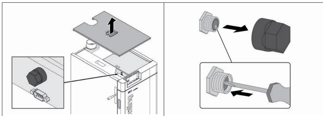
Dès que la température baisse en dessous de 75 °C environ, il est possible de déverrouiller mécaniquement le STB.
