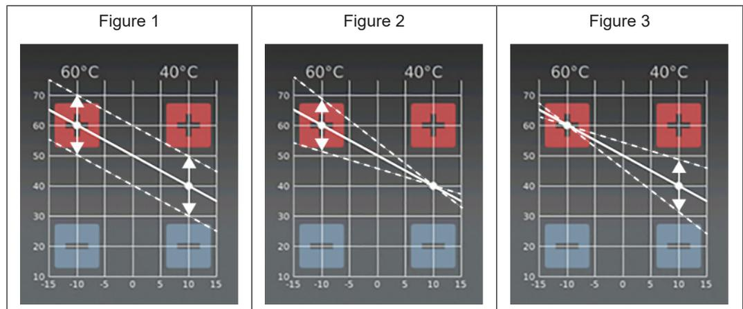
La courbe de chauffage peut être ajustée en fonction de la situation en appuyant sur « + » ou « - » à une température extérieure de  $\pm 10\text{ °C}$ .
